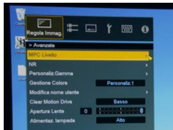
La nota più interessante riguarda la calibrazione dei primissimi gradini della scala dei grigi: nella serie precedente era presente un controllo che agiva solo sulla luminanza (quindi contemporaneamente sulle tre componenti RGB). Ora il controllo è separato per le tre componenti
